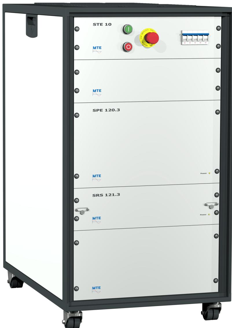
El Sistema SPE es una fuente de potencia electrónica de corriente y tensión (carga fantasma) para el ensayo de contadores de electricidad o el ensayo de otros instrumentos los cuales usen corriente y tensión.
